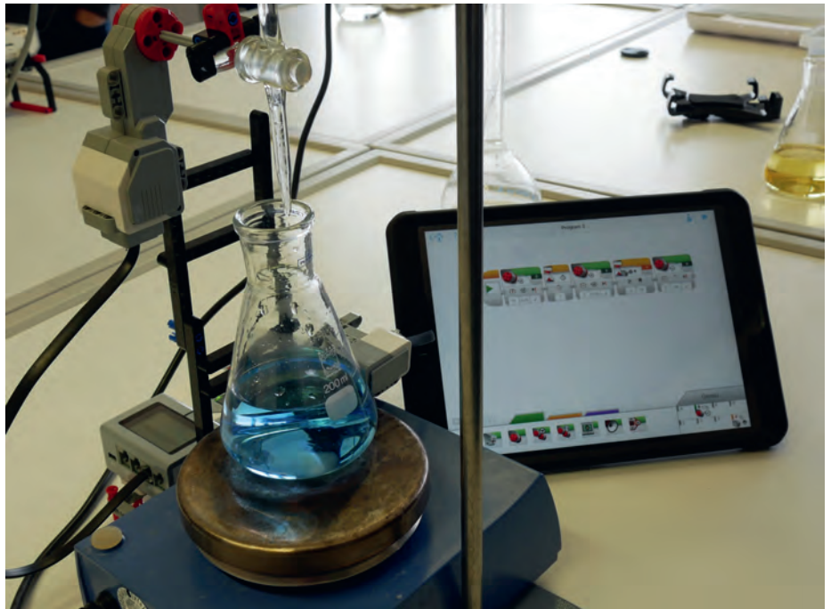
Mit Hilfe des Tablets kontrollieren die Berufsfachschüler das Steuerprogramm mit Aktions- und Programm-Ablaufblöcken zum Öffnen und Schließen der Bürette.
